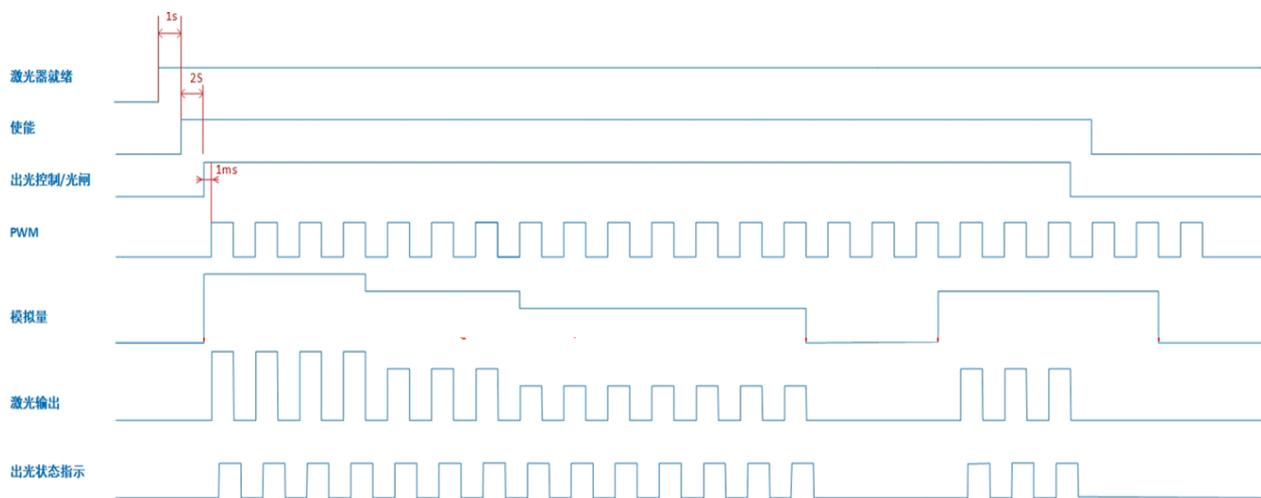
说明：三代激光器外控信号需要按照时序图进行控制，使能作为上高压信号。
